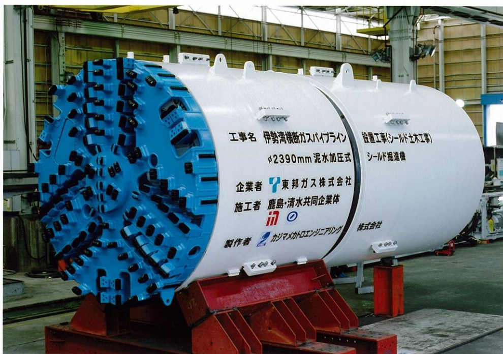
ガスパイプライン敷設用シールドマシン (提供：東邦ガス)
